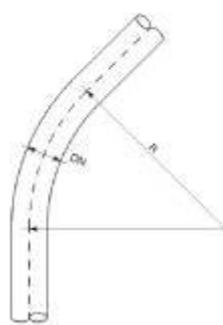
d) Los tubos de acero también admiten ser curvados, pudiendo obtenerse dicho curvado bien en frío (en la propia obra) o bien en caliente (en fábrica). En el primer caso (curvado en frío) pueden obtenerse radios de curvatura de hasta 5 ó 10 veces el DN, mientras que en el segundo caso (curvado en caliente) no deben excederse curvaturas de 20 ó 40 veces el DN.
